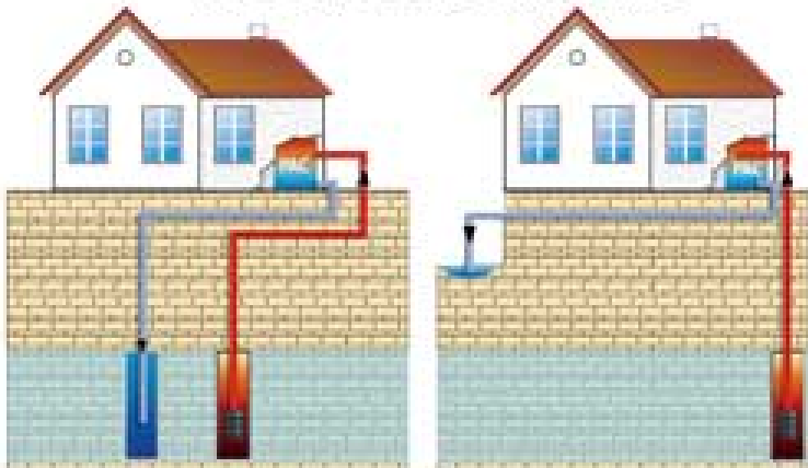
PAC sur eaux souterraines
