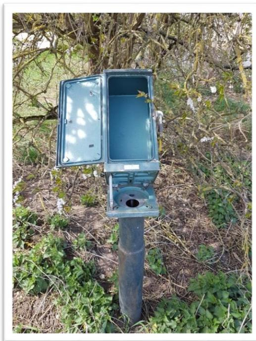
*Centrale OTT Thalimèdes (roue codeuse) remplacée par centrale OTT Orphéus-mini (mesure niveau + température) dans boîtier historique (anciennement piézographe) - Oberentzen*
