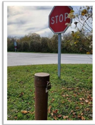
*Point équipé d'une centrale dans le tubage avec fermeture sécurisée à Lauterbourg*
