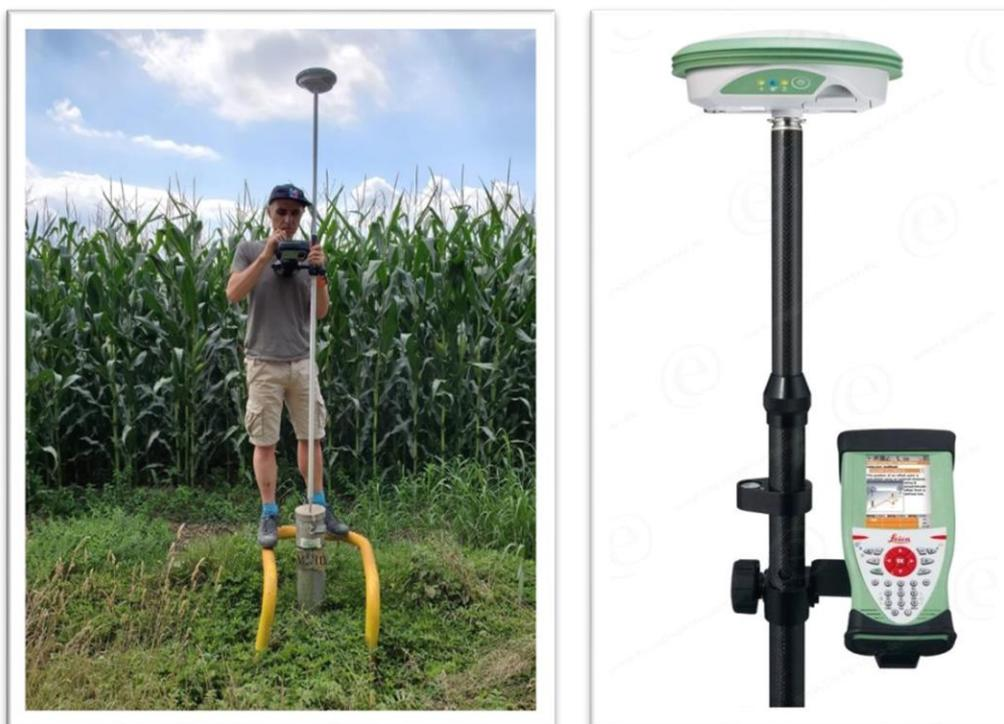
*Matériel de nivellement GPS par satellites*
