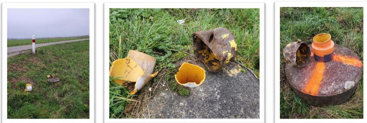
*Piezomètre abîmé par une débroussailleuse à Hoerd*
