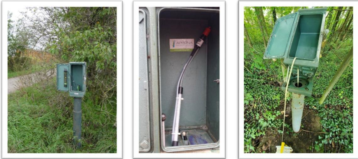
*Centrale OTT Thalimèdes et SEBA Dipper PT remplacées par centrale OTT Orphéus-mini (mesure niveau + température) dans boîtier historique (anciennement piézographe)*
