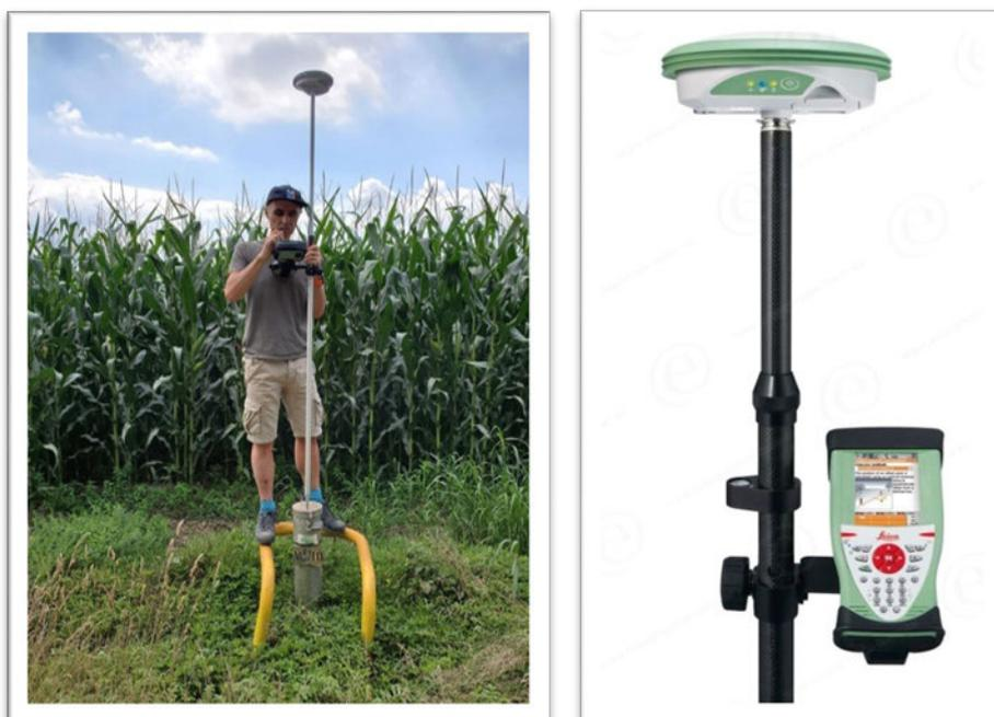
*Matériel de nivellement GPS par satellites*
