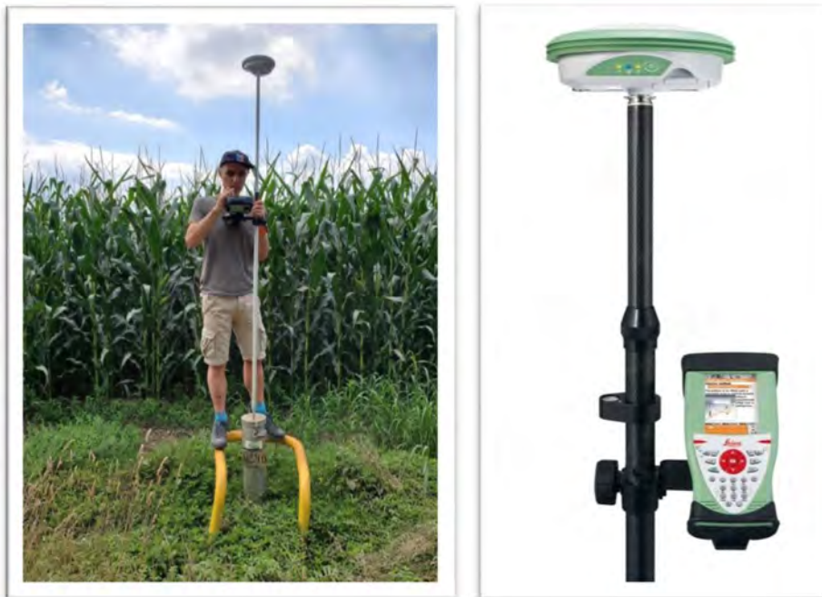
Matériel de nivellement GPS par satellites
