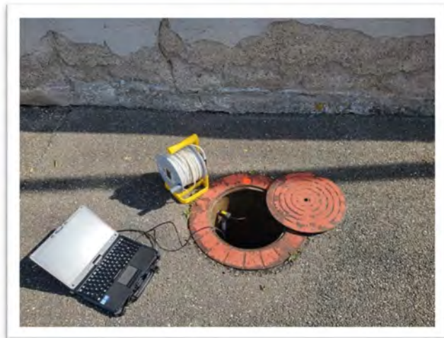
Installation centrale OTT Orphéeus-mini dans puits incendie à Niederhergheim
