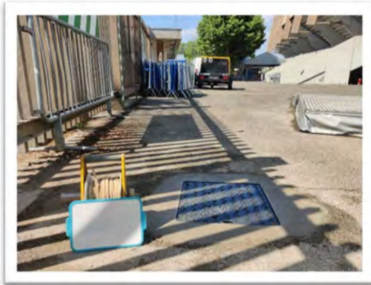
Ancien ouvrage arrêté et nouveau piézomètre équipé à Strasbourg - la Meinau
