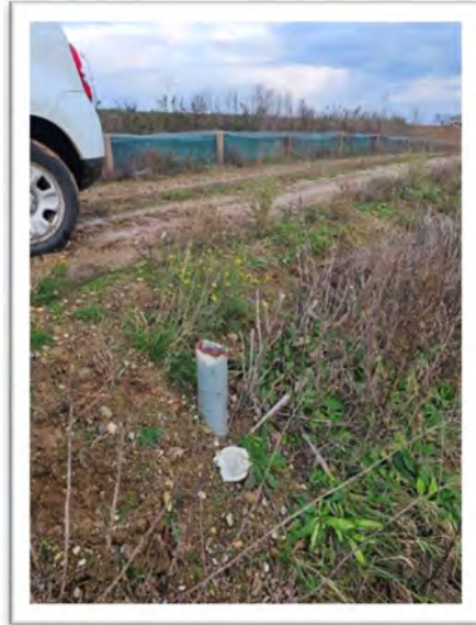
Piezomètre détruit à Wolfisheim (hors réseau APRONA)
