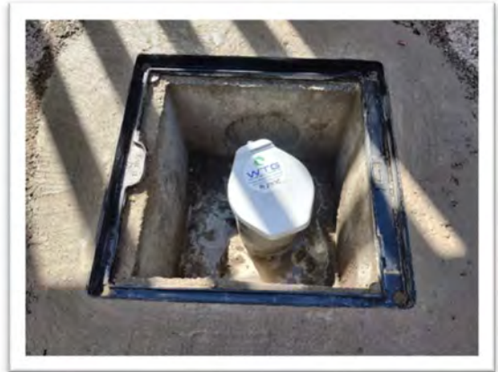
Ancien ouvrage arrêté et nouveau piézomètre équipé à Strasbourg - la Meinau
