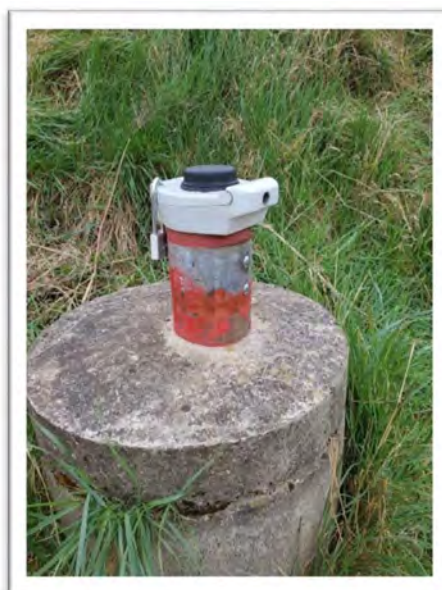
Travaux pour équiper et sécuriser le piézomètre avec une centrale télétransmise à Offendorf
