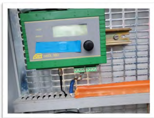
Coffret sécurisé et centrales NetDL 500 puis Ecolog 1000 sur point à Guémar
