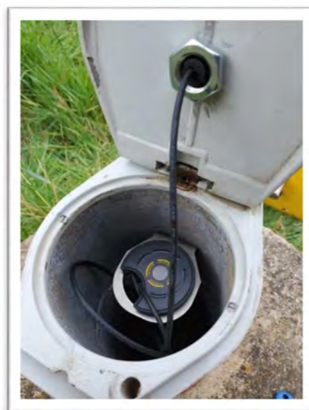
Travaux pour équiper et sécuriser le piézomètre avec une centrale télétransmise à Offendorf
