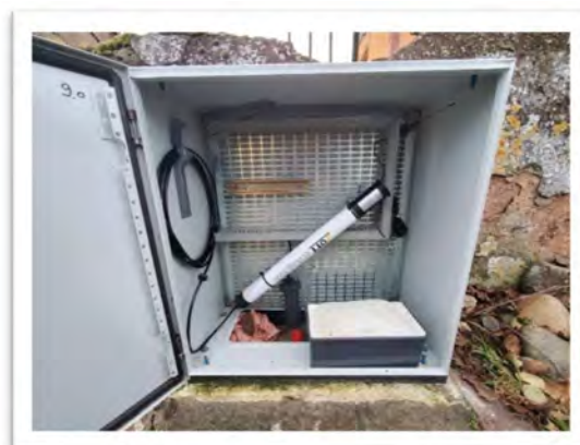
Coffret sécurisé et centrales NetDL 500 puis Ecolog 1000 sur point à Guémar
