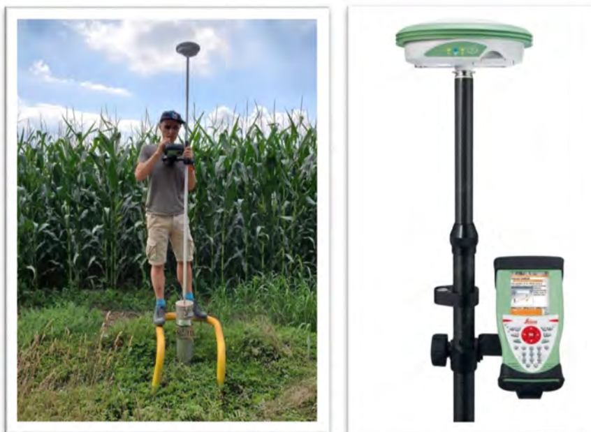
Matériel de nivellement GPS par satellites
