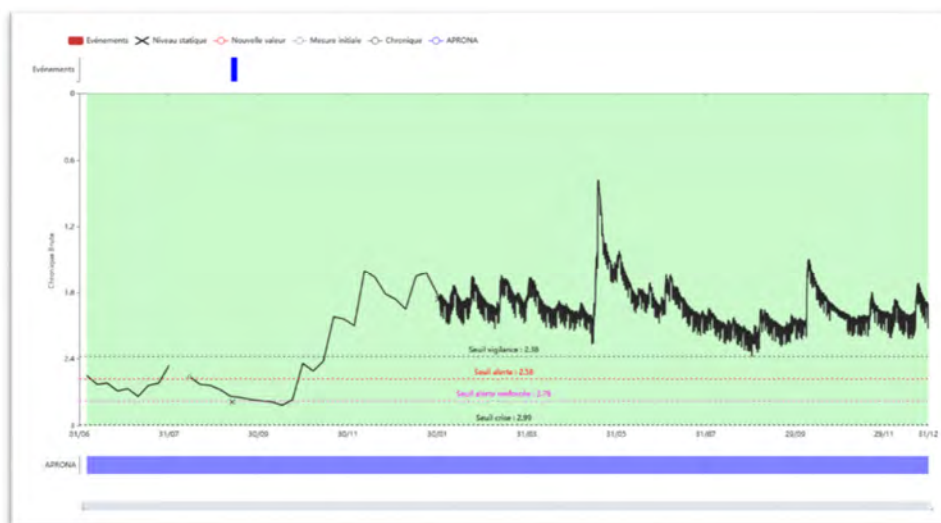
Influence pompage mis en évidence depuis installation centrale à Brumath
