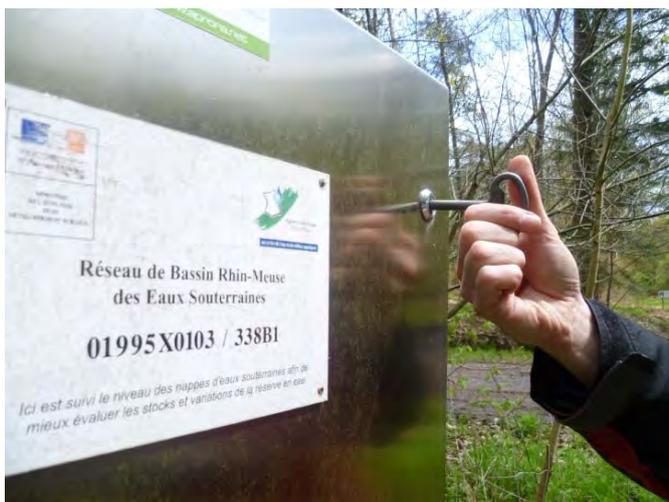
Insérer la clé spéciale boitier AERM et déverrouiller la serrure.
