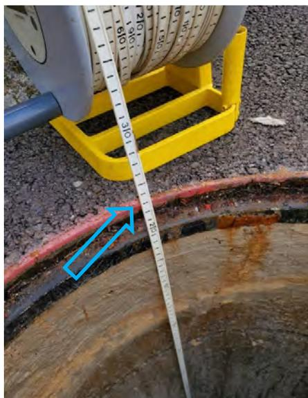
Le repère de nivellement est indiqué par la flèche **bleue** sur le côté le plus proche du mur.
