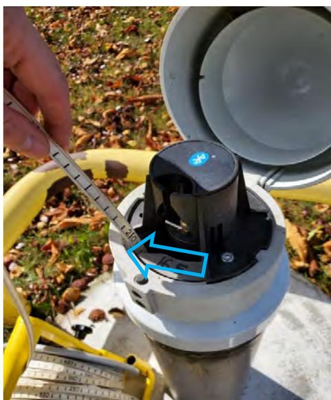
Le repère de nivellement est indiqué par la flèche **bleue**, au niveau du bord extérieur le plus haut.
