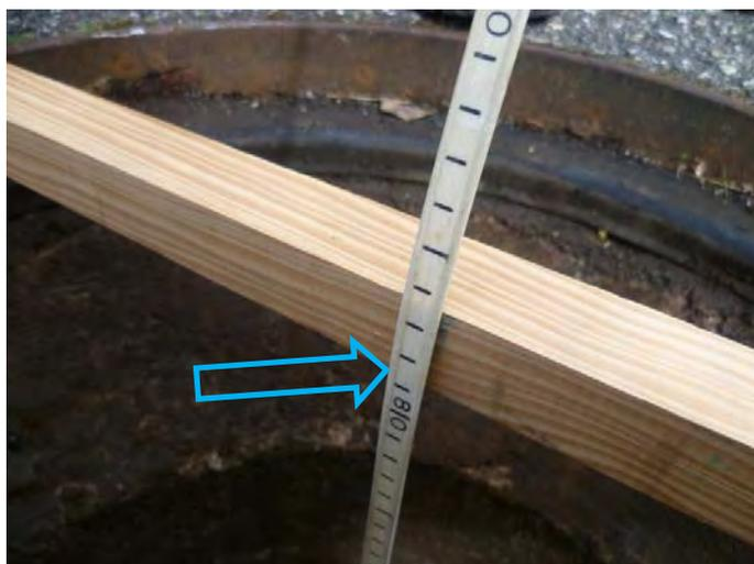
Le repère de nivellement est indiqué par la flèche **bleue** sur le bord inférieur de la règle en bois.
