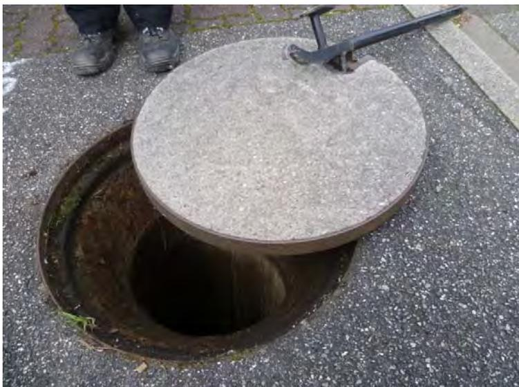
Tirer le couvercle vers soi à l'aide du crochet en veillant à ce qu'il recouvre la moitié de l'ouverture afin de respecter les prescriptions de la **PROCEDURE SECURITE PIEZOMETRE REICHSTETT**.
