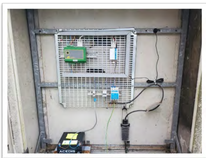
Centrale Duosens + modem GSM + Sonde pression remplacée par centrale Ecolog 500 à Cernay
