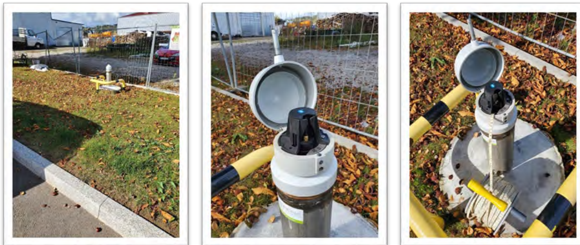
Tête spécifique avec arceau de protection sur point RCS à Habsheim
