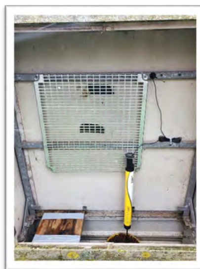
Centrale Duosens + modem GSM + Sonde pression remplacée par centrale Ecolog 500 à Cernay
