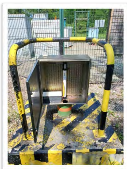
Centrale Ecolog 500 télétransmise en place à Fessenheim
