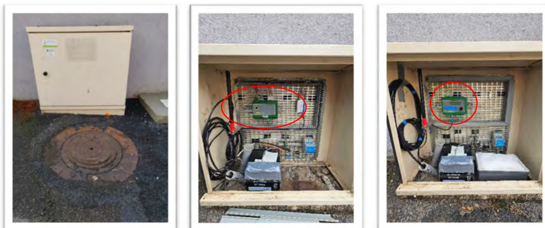
FIGURE 9 : BOITIER ABRITANT LA CENTRALE TELETRANSMISE ET REMPLACEMENT DU MODELE OTT DUOSENS PAR NETDL 500 A HETTENSCHLAG
