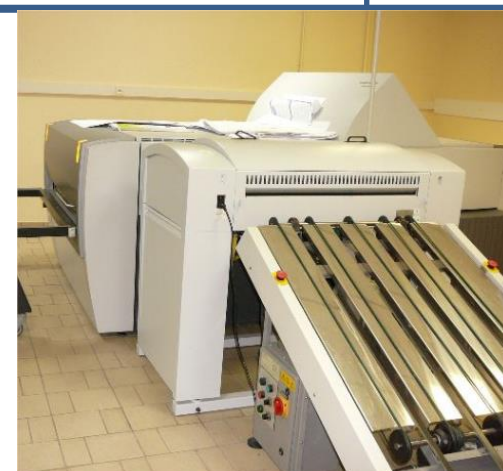
Imprimerie : CTP Thermique sans chimie
