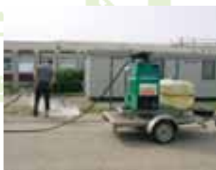
Désherbage à l'eau chaude à 90°C
