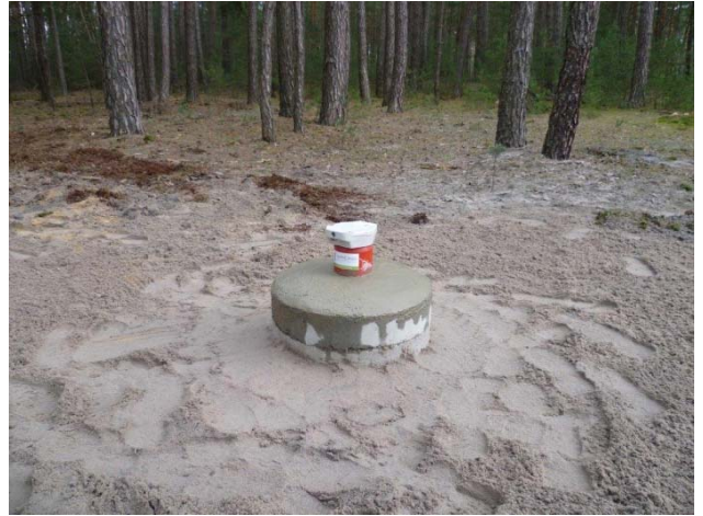
Photo 1 : Dispositif de protection de la tête du piézomètre
